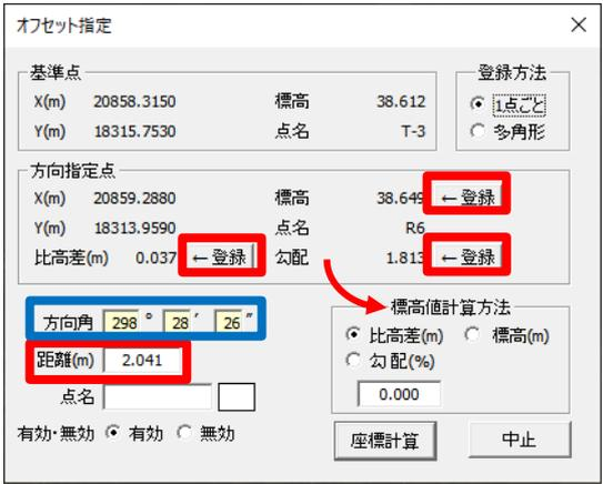
1. 基準点をドラッグする際、「Shift」キーを押しながらドラッグを行い、方向指定点とする点の近くでマウスのボタンを離します。方向指定点に基づいた方向角(□部分)が入力された状態でダイアログが開きます。
