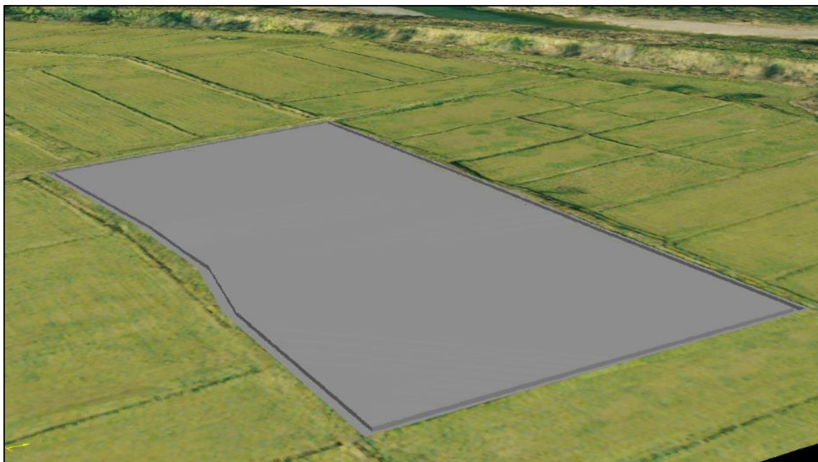
「三角網計算考慮」機能を使用して側溝を作成した例
